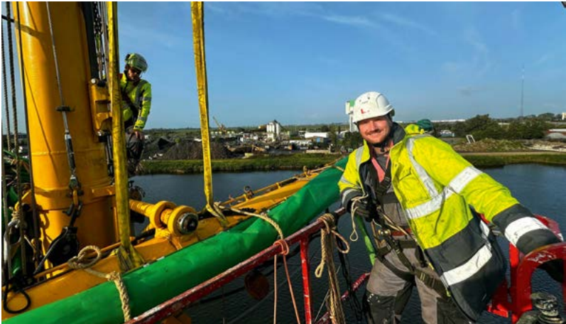
Und schon sind die Helme im Einsatz: Bootsmann Lennart Koch beim Montieren der zur Takelage gehörenden Voruntermarsrah.
