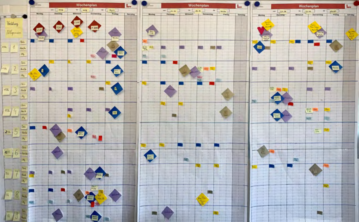
Orange für den Vermesser, rot für den Prüfstatiker: Dank der farbigen Klebezettel haben alle Projektbeteiligten jederzeit einen guten Überblick über die geplanten Arbeitsabläufe.
